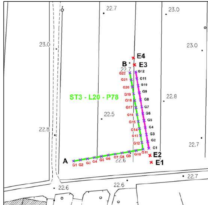
Esempio di geometria ESAC/MASW
